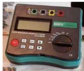
**TELURÓMETRO:** Nos permite verificar la resistencia de puesta a tierra de la instalación. Seguridad.
