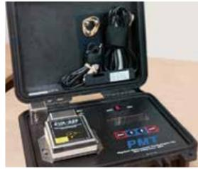
**ANALIZADOR VIBRACIONAL EVA – 625:** Registra y permite afinar la suavidad del viaje en los tres ejes. Grafica curvas de aceleración, velocidad y desplazamiento. Confort.
