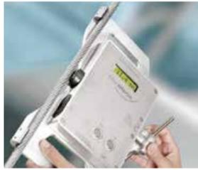
**BRUGG RPM:** Verifica y equilibra la tensión de los cables de tracción, alargando de este modo su vida útil.
